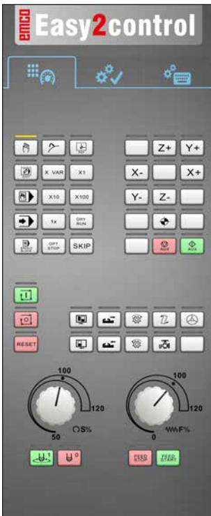
Panneau de commande de la machine
