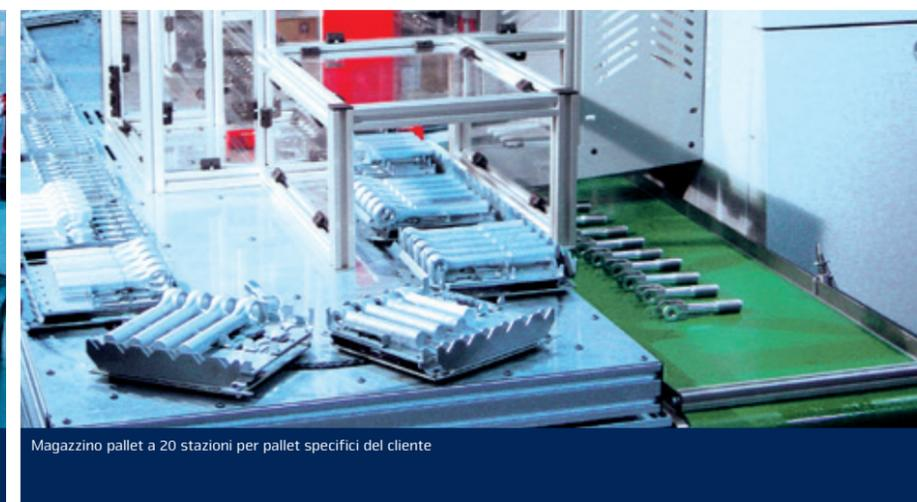
Magazzino pallet a 20 stazioni per pallet specifici del cliente
